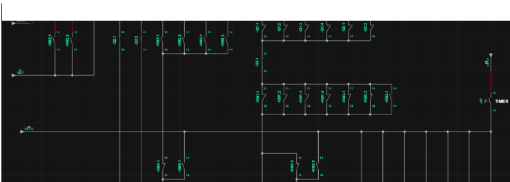
Gambar 4. 22 Koil Kontaktor Fan 5-6 belum aktif
