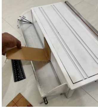
Gambar 4. 7 Proses Bending Akrilik
