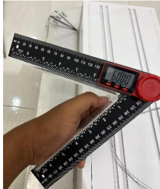
Gambar 4. 12 Pengukuran Sudut Hasil Penekukan 60^\circ
