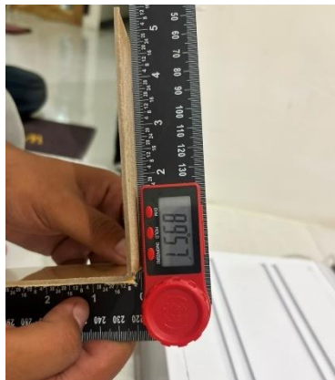
Gambar 4. 14 Pengukuran Sudut Hasil Penekukan 90^\circ
