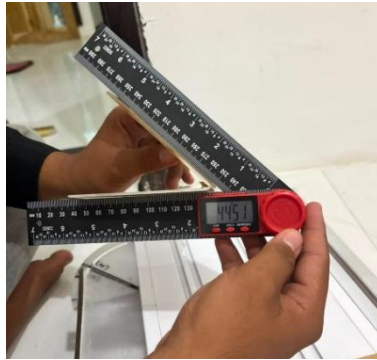
Gambar 4. 10 Pengukuran Sudut Hasil Penekukan 45^\circ
