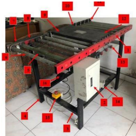
Gambar 2. 1 Mesin Pemanas Dan Bending Akrilik
