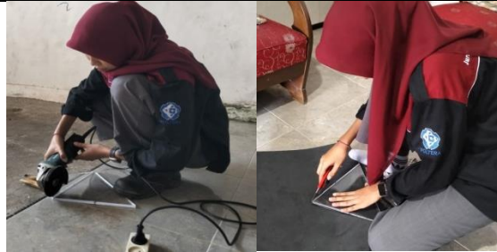
Gambar 3. 6 Proses pemotongan akrilik dan spons
