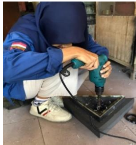
Gambar 3. 7 Proses pengeboran dan membuat drat
