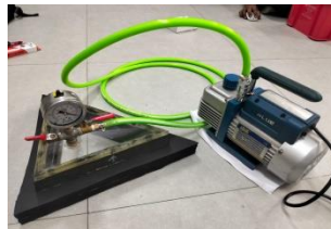
Gambar 4. 1 Menyambungkan Box Dengan Pompa
