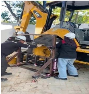
Gambar 4.7 Hasil Pengujian Alat Bantu Pemegang Roda
