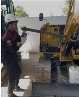
Gambar 3. 9 Pemutaran Alat Supaya Gland Terbuka
