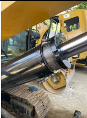
Gambar 3. 10 Kondisi Gland Pada Saat Terbuka
