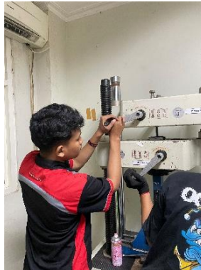
Gambar 4. 1 Proses Pengujian tarik (S50C)
