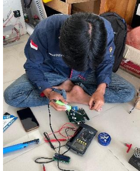
Gambar 4.2. Perakitan komponen pada PCB
