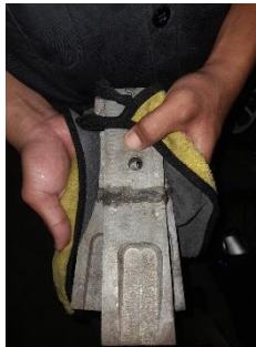
Gambar 4.2 Persiapan Spesimen Gigi Bucket Sebelum Pengujian
