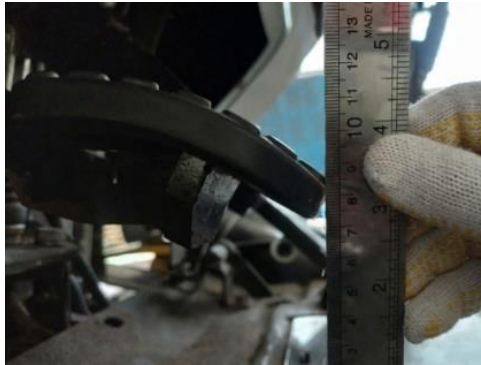
Gambar 4. 1 Pengukuran Tinggi Clutch Pedal
