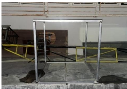
Gambar 3. 4 Pembuatan Rangka Kontainer Pengering Ikan Teri
