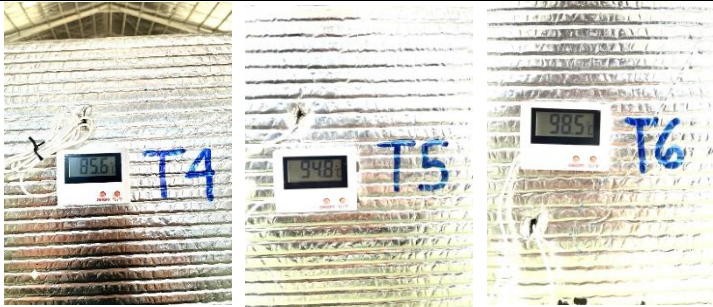
Gambar 4. 5 Pengukuran Suhu Sisi Kiri Tanpa Blower
