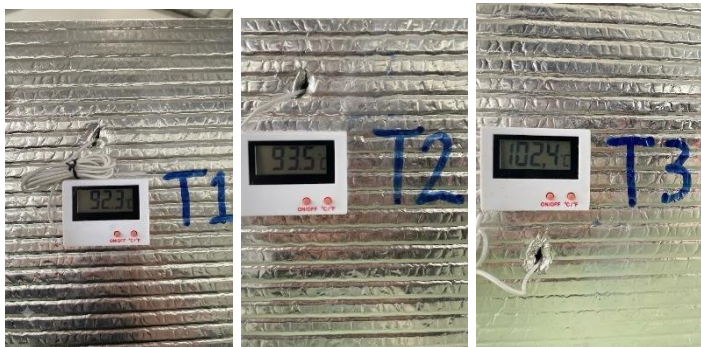
Gambar 4. 4 Pengukuran Suhu Sisi Kanan Tanpa Blower
