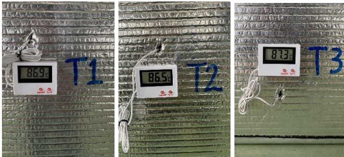
Gambar 4. 6 Pengukuran Suhu Sisi Kanan Menggunakan Blower
