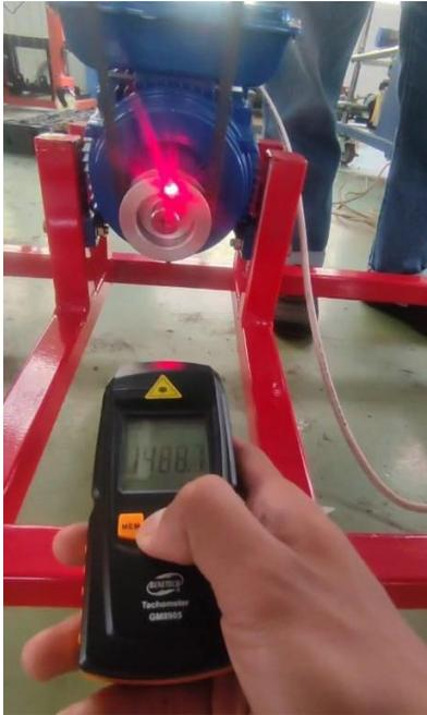
Gambar 4. 10 Pengujian putaran pada pulley driver
