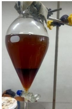
Gambar 3. 9 Proses pemisahan hasil esterifikasi
