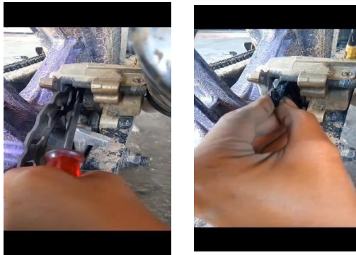
Gambar 4.2 pemasangan kampas rem komposit
