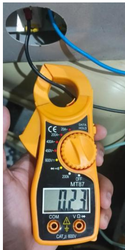
Gambar 4. 4 Pengukuran arus dengan clamp ampere
