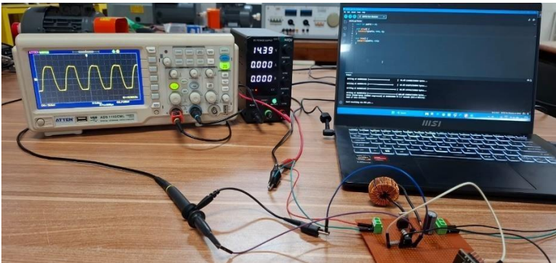
Gambar 4. 9 Sinyal keluaran dari percobaan Rangkaian Buck Converter
