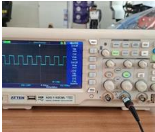
Gambar 4. 6 Hasil keluaran sinyal dengan frekuensi 20kHz
