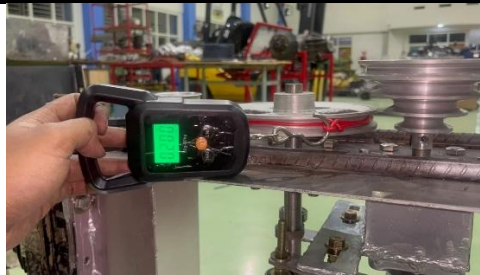
Gambar 4. 5 Proses pengambilan data gaya pada cam Didapatkan gaya sebesar 0,2 kg dengan jari-jari pulley 0,087 m.
