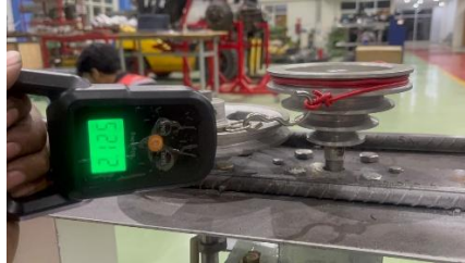
Gambar 4. 4 Proses pengambilan data gaya pada poros can .
