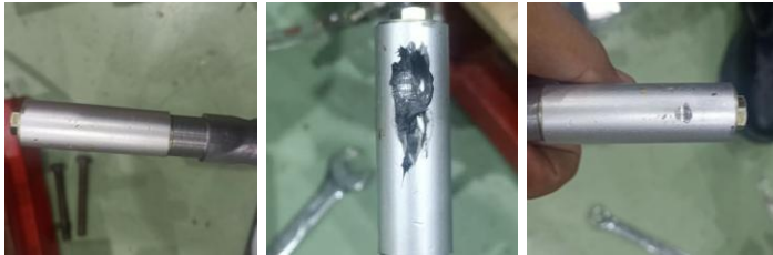
Gambar 4. 3 Kondisi poros sebelum dan sesudah pengujian
