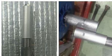
Gambar 4. 2 Kondisi poros sebelum dan sesudah pengujian
