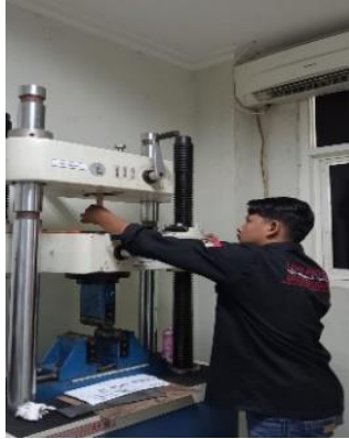
Gambar 3. 11 Memasang Spesimen Uji Tarik
