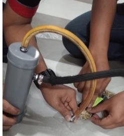
Gambar 3. 9 Melakukan Vakum Pada Spesimen
