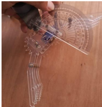
Gambar 4. 2 mengukur sudut putaran servo
