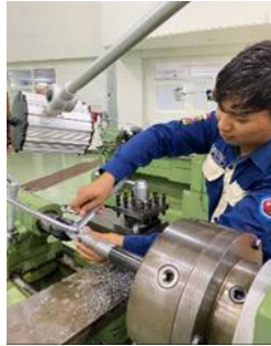
Gambar 4. 4 Proses pembuatan Poros torque converter di bengkel kontruksi
