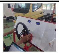
Gambar 4. 12 Pengujian putaran kedua roda pada posisi lurus
