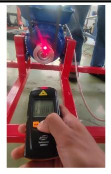
Gambar 4. 10 Pengujian putaran pada pulley driver Sumber : Dokumentasi pribadi
