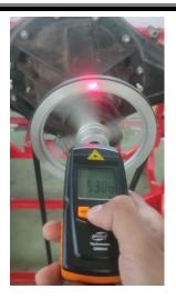
Gambar 4. 11 Pengujian putaran pada pulley driven
