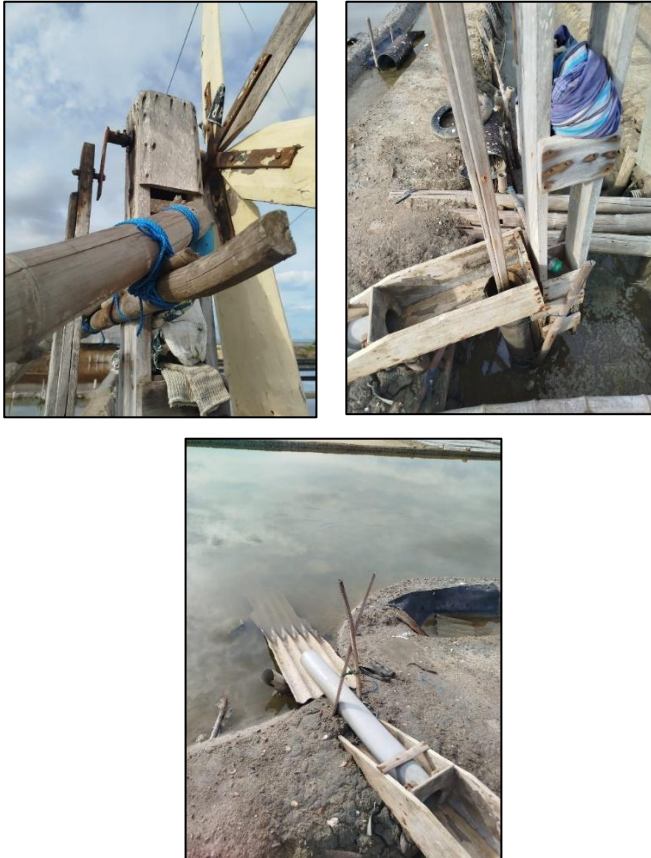
Gambar 2. 2 Kincir Angin sebagai Pemompaan pada daerah tambak
